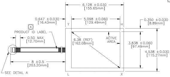
NOTE: CABLE ATTACHED TO LEFT SIDE OF TOUCHSCREEN AT CENTER POINT AS SHOWN.
