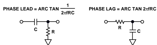
Phase Shift Circuits
