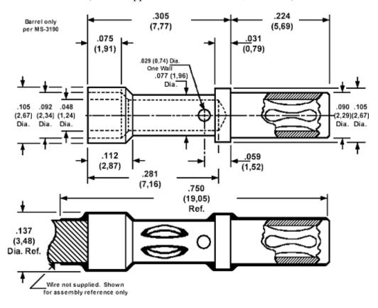
Min hole depth (socket) .185 (4,70)
