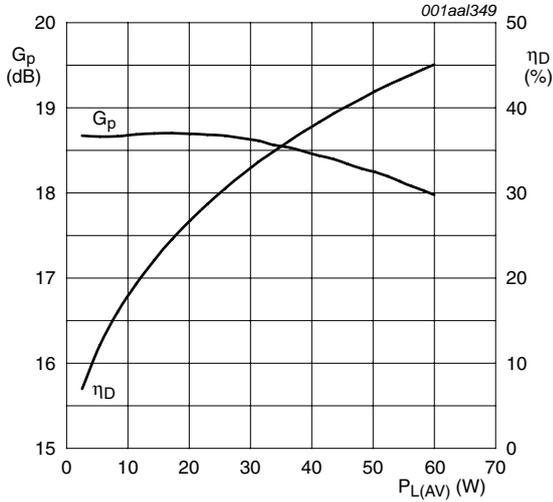
$V_{DS} = 28\text{ V}$ ;  $I_{Dq} = 950\text{ mA}$ ;  $f_1 = 2137.5\text{ MHz}$ ;  $f_2 = 2142.5\text{ MHz}$ ; carrier spacing 5 MHz.
