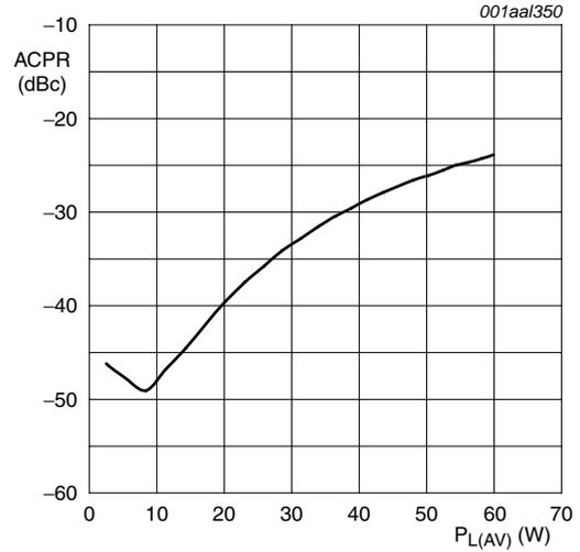
$V_{DS} = 28\text{ V}$ ;  $I_{Dq} = 950\text{ mA}$ ;  $f_1 = 2137.5\text{ MHz}$ ;  $f_2 = 2142.5\text{ MHz}$ ; carrier spacing 5 MHz.
