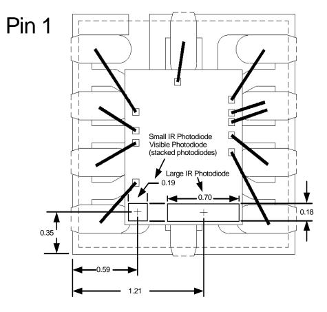
**Figure 13. Photodiode Centers**
