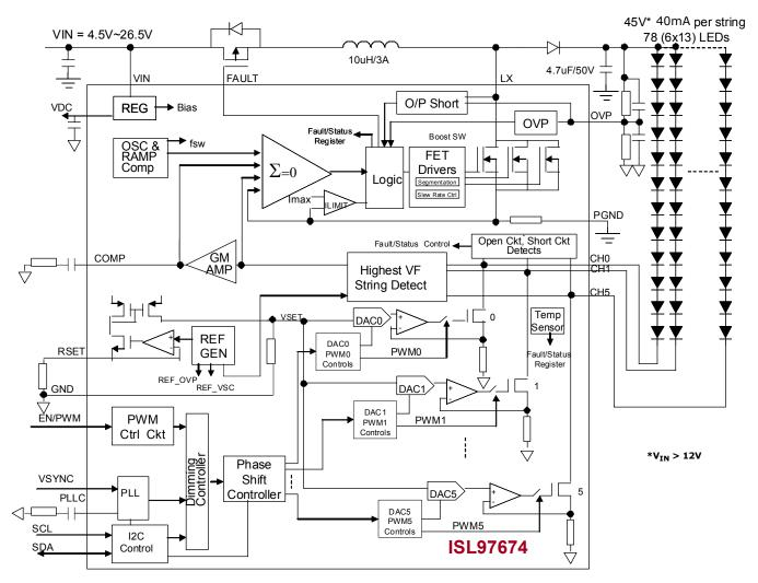
FIGURE 2. ISL97674 BLOCK DIAGRAM
