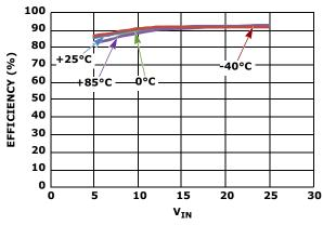
FIGURE 7. EFFICIENCY vs  $V_{\rm IN}$  vs TEMPERATURE AT 20mA (100% LED DUTY CYCLE)
