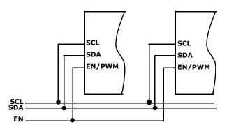
FIGURE 41. MULTIPLE DRIVERS OPERATION
