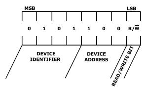
FIGURE 29. SLAVE ADDRESS BYTE DEFINITION
