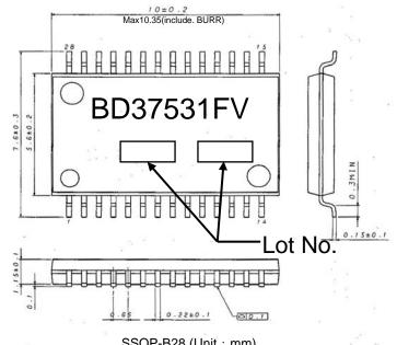
SSOP-B28 (Unit : mm)
