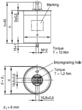
Creepage distance 12.7 mm min. Clearance 9.6 mm min.
