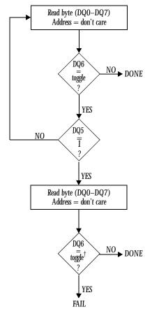
$^{\dagger}$ DQ6 rechecked even if DQ5 = 1 because DQ6 may stop toggling when DQ5 changes to 1.
