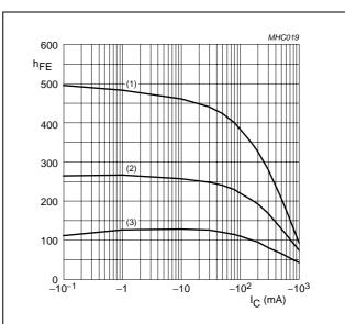
**TR2 (PNP);**  $V_{CE} = -2 \text{ V}.$
