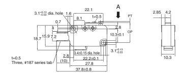
**D3V-21G1M-1** □ 4**A-**△ **D3V-161M-1** □ **5**-∆ **D3V-111M-1**□**5**-∆ **D3V-111M-1** □ **4**-∆ **D3V-61M-1** □ **4-** △ **D3V-6G1M-1**□**3**-∆ **D3V-011M-1**□**3-**△
