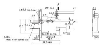
**D3V-21G5M-1**□4**A-**△ **D3V-165M-1**□**5-**△ **D3V-115M-1**□**5-**△  $\textbf{D3V-115M-1} \square \textbf{4-} \Delta$ **D3V-65M-1** □ **4-** △ **D3V-6G5M-1**□**3-**△ **D3V-015M-1** □ **3-** △
