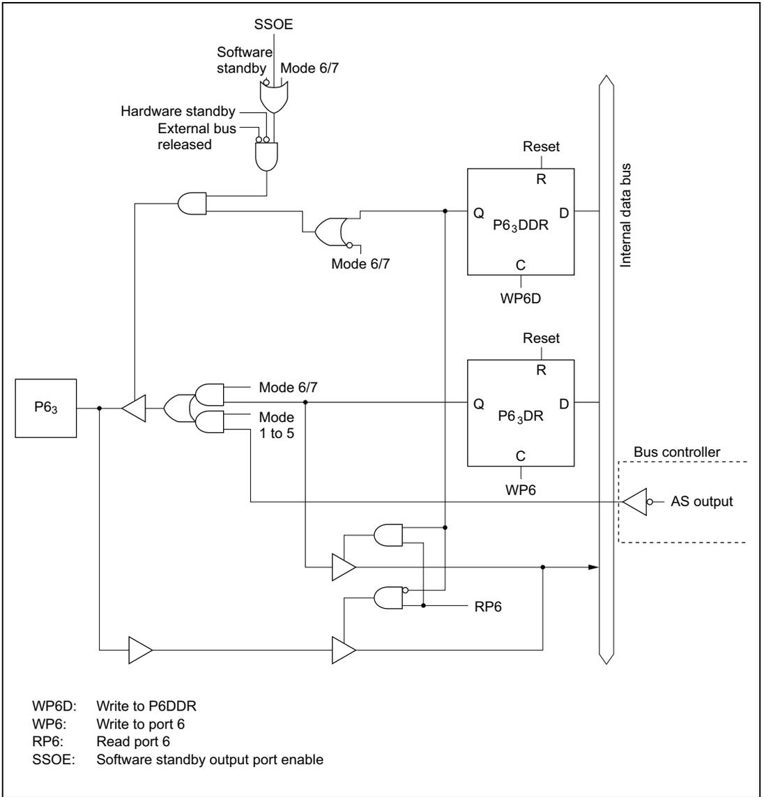
Figure C.6 (d) Port 6 Block Diagram (Pin P6<sub>3</sub>)
