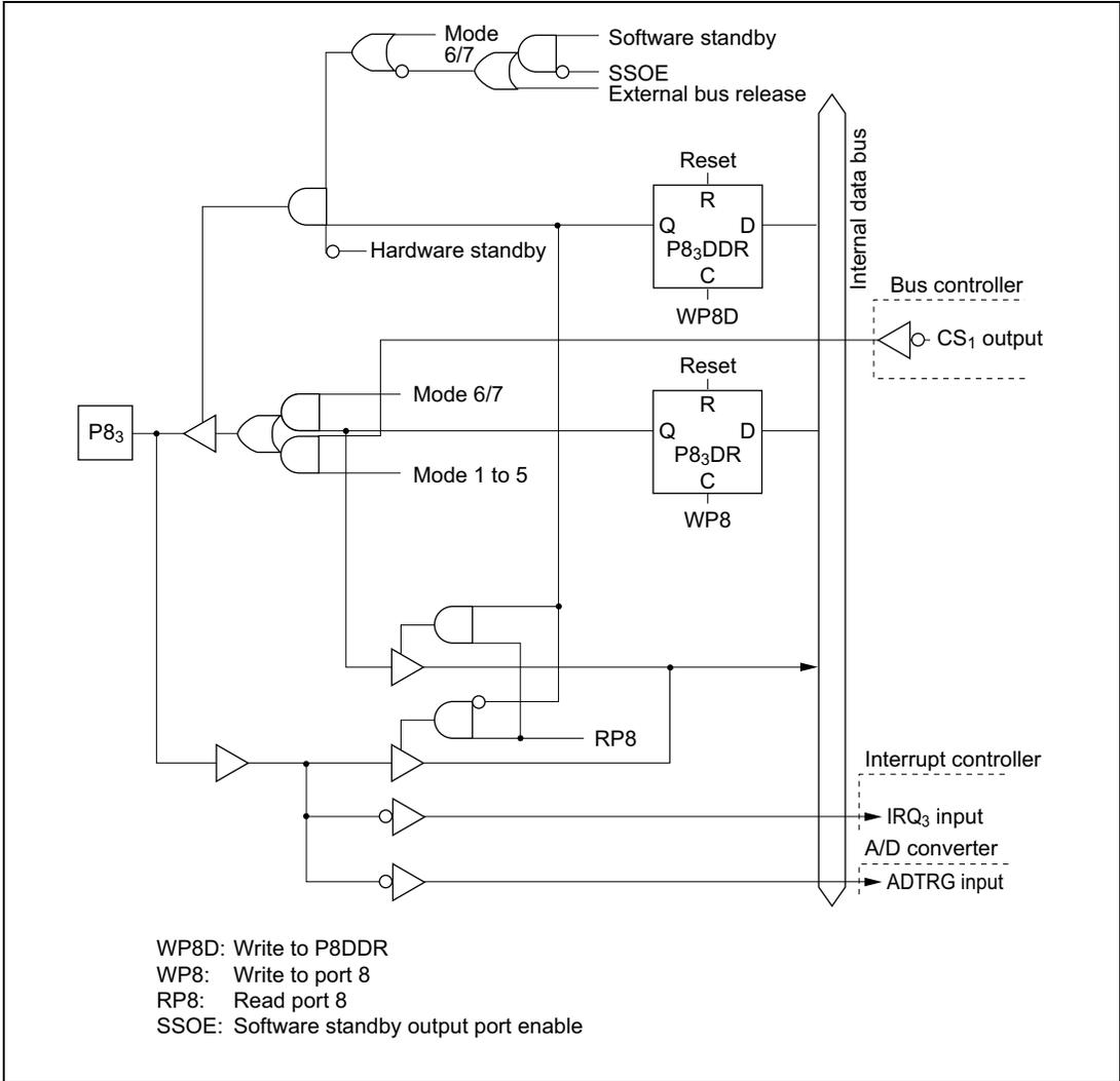
**Figure C.8 (d) Port 8 Block Diagram (Pin P8<sub>3</sub>)**
