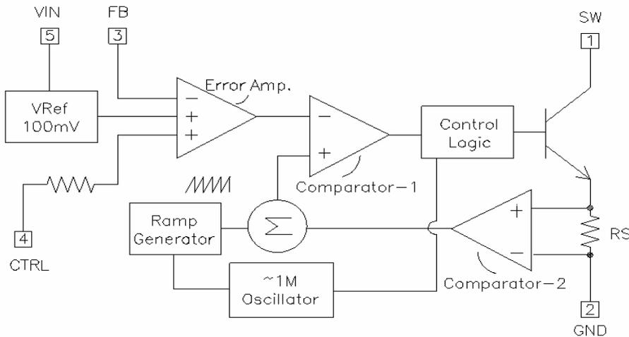
**Figure 3: YB1522 Block Diagram**
