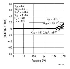
Figure 13. +FS Error vs R<sub>SOURCE</sub> at IN<sup>+</sup> or IN<sup>-</sup>
