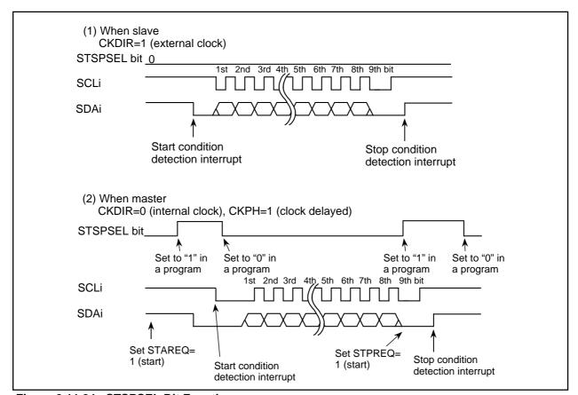
Figure 2.11.24. STSPSEL Bit Functions
