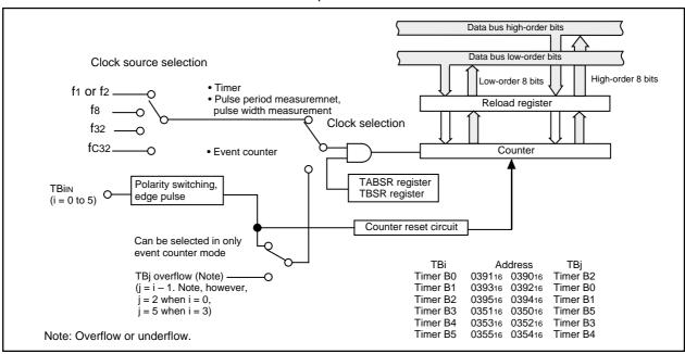
Figure 2.10.14. Timer B Block Diagram
