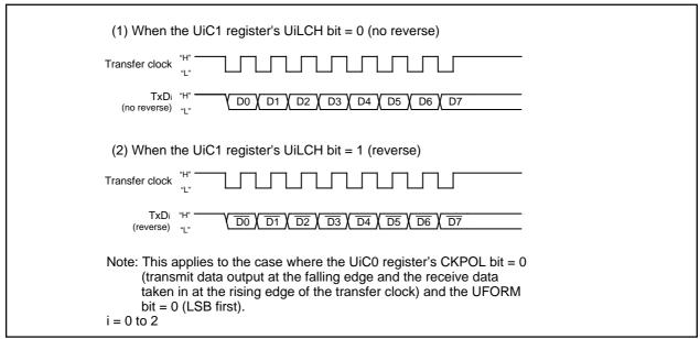
Figure 2.11.12. Serial Data Logic Switching
