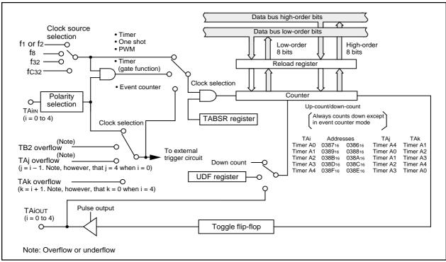
Figure 2.10.3. Timer A Block Diagram
