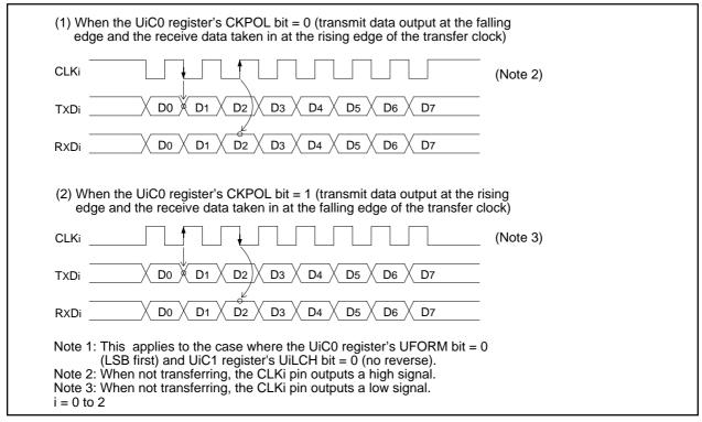
Figure 2.11.10. Transfer Clock Polarity
