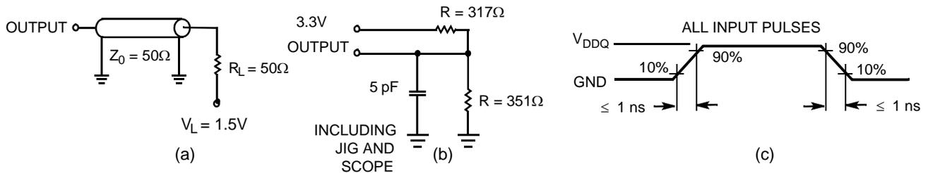
**2.5V I/O Test Load**
