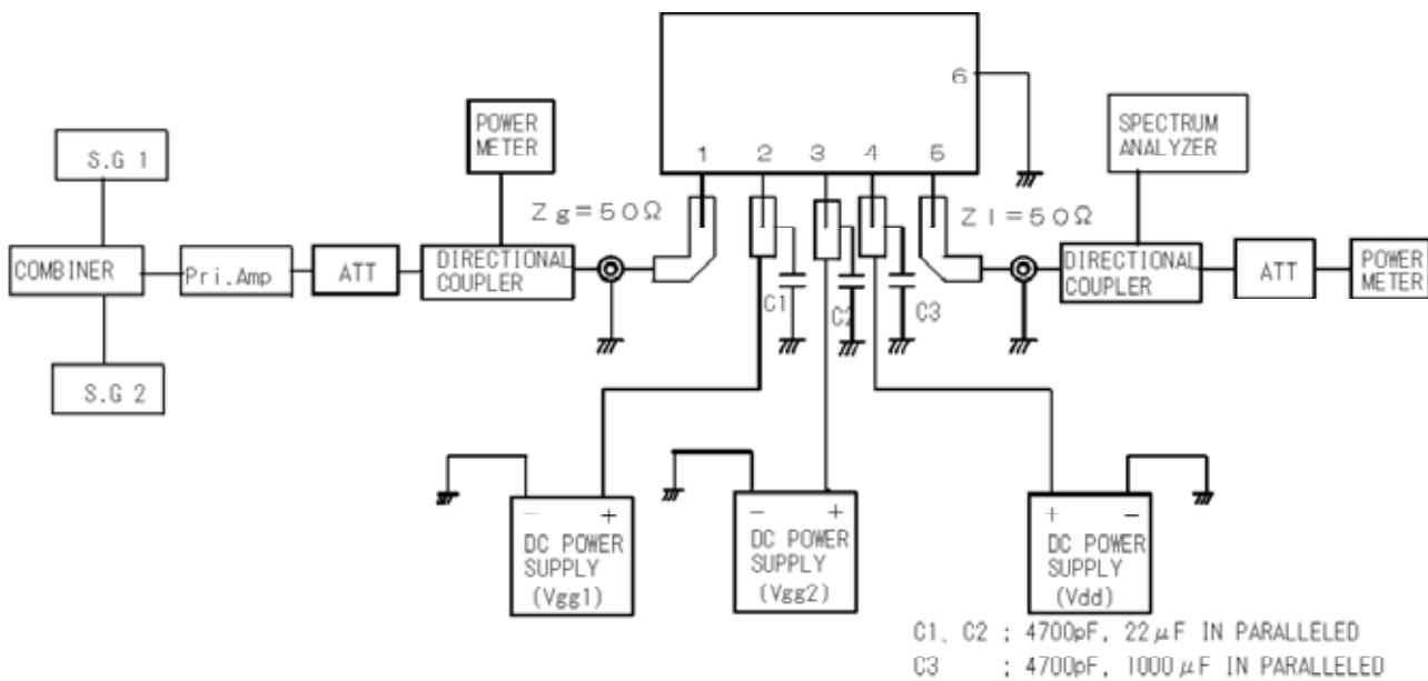
TEST BLOCK DIAGRAM (SINGLE CARRIER)
