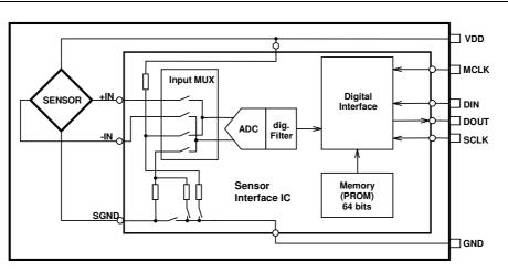
Fig.: 1 Block Diagram 5536
