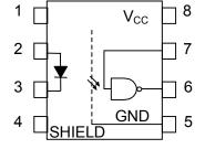
2:ANODE 3:CATHODE 4:N.C. 5:GND 6:Vo(OUTPUT) 7:V<sub>E</sub>(ENABLE) 8:V<sub>CC</sub>
