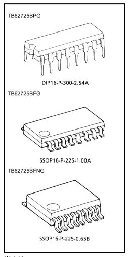
Weight DIP16-P-300-2.54A: 1.11 g (typ.) SSOP16-P-225-1.00A: 0.14 g (typ.) SSOP16-P-225-0.65B: 0.07 g (typ.)
