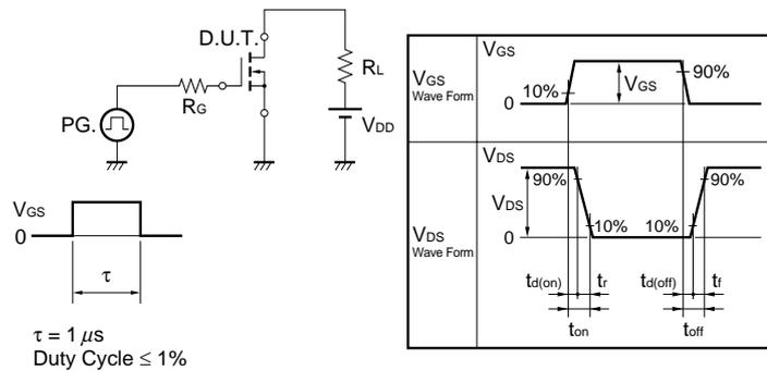
**TEST CIRCUIT 3 GATE CHARGE**
