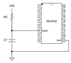
FIGURE 9. VOLTAGE FEED FORWARD CONTROL
