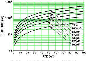
FIGURE 3. DEADTIME (DT) vs CAPACITANCE
