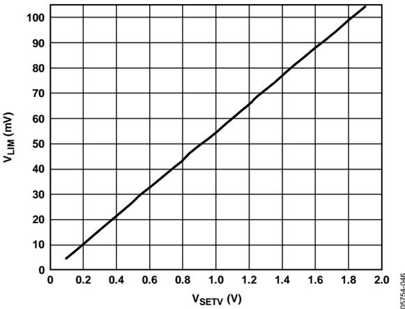
Figure 12. V<sub>LIM</sub> vs. V<sub>SETV</sub>
