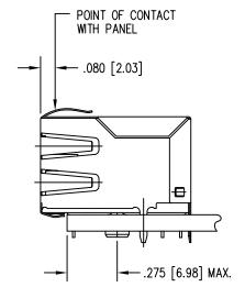
THE SUGGESTED PANEL OPENING IS INTENDED TO GIVE THE USER THE ABILITY TO HAVE REASONABLE JACK / PANEL CLEARANCES YET MAINTAIN RELIABLE GROUNDING CAPABILITY.
