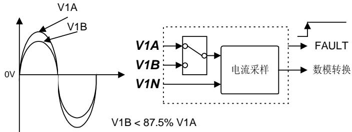
如果开始时 V1A 作为计量，且 V1B 不断增加，当 V1B 大于 114% V1A 时，FAULT 指示会变亮，此时将会按照 V1B 进行计量，并且只有当 V1A 大于 114% V1B 时才会重新按照 V1A 计量，但是只要 V1A 与 V1B 的差值小于 12.5% V1B，FAULT 指示不亮。
