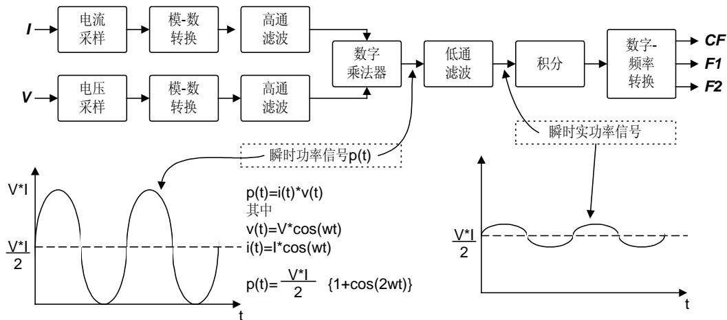
在通过对电流电压信号高精度采样及模数转换后，电流电压信号通过数字乘法器得到瞬态功率信号  $p(t)$ 。让  $p(t)$  通过一个截至频率很低（如 1Hz）的取直低通滤波器，把即时实功率信号取出来。然后对该实功率信号对时间进行积分，得到能量的信息。如果选择积分时间十分的短，可以认为得到的是即时能量消耗的信息，也可以认为是即时功率消耗的信息，因为前后两者成正比关系。如果选择的较长的积分时间，得到的是平均的能量消耗的信息，同样也可以认为是平均功率消耗的信息。
