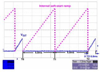
FIGURE 5. OVERCURRENT RETRY OPERATION
