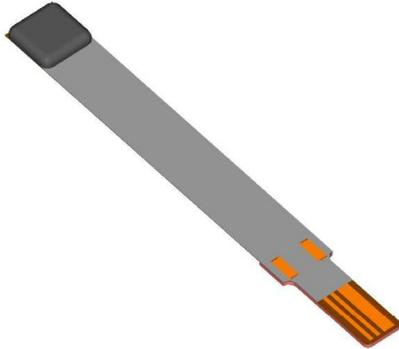
TSic auf Flex montiert (COF = Chip on Flex)
