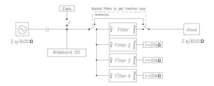
Note :  $Z_R = 270 \text{ ohm} + (750 \text{ ohm} // 150 \text{nf})$
