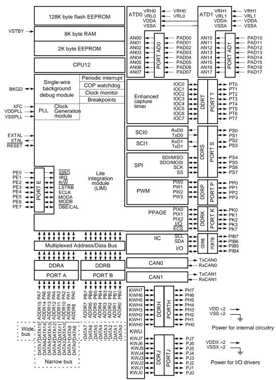
Figure 2 MC68HC912DG128A Block Diagram
