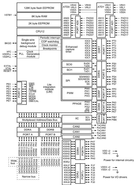
Figure 1 MC68HC912DT128A Block Diagram
