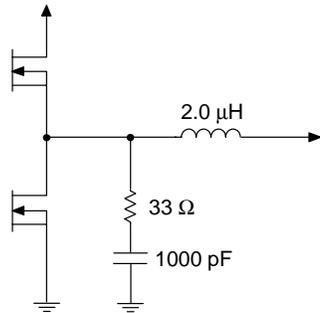
**Figure 18. Filter Components**
