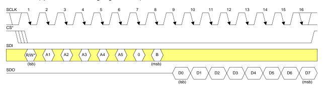
Figure 5-3 **SERIAL PORT OPERATION MODE 3**
