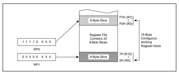
Figure 2-9. Non-Contiguous 16-Byte Working Register Block
