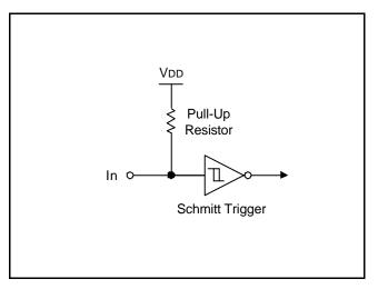
Figure 1-5. Pin Circuit Type B (nRESET)
